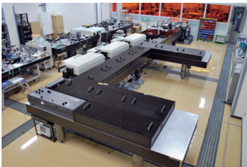
図3 京都大学化学研究所の高強度短パルスレーザー装置 (T 6 レーザー) (奥の窓の向こう側がレーザー照射室)
