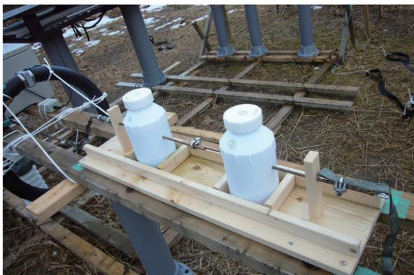
図 3. 野外放電実験反応容器の設置状況
