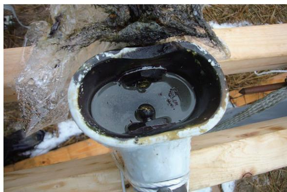
図 2. 陶磁器製オイルカップへの誘雷結果
