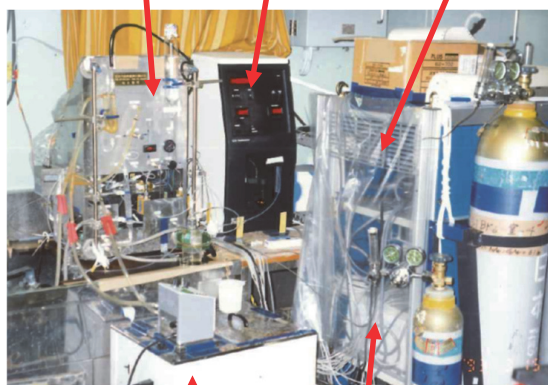
写真1. 「しらせ」第5観測室に設置した(左)全炭酸測定装置の1号機と、(右)凌風丸IVで使用されている最新の全アルカリ度測定装置と全炭酸測定装置の前処理装置.
