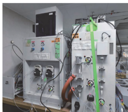
写真1. 「しらせ」第5観測室に設置した(左)全炭酸測定装置の1号機と、(右)凌風丸IVで使用されている最新の全アルカリ度測定装置と全炭酸測定装置の前処理装置.
