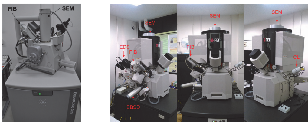
図1. 筆者が使用している集束イオン-電子ビーム複合装置 (FIB-SEM)
