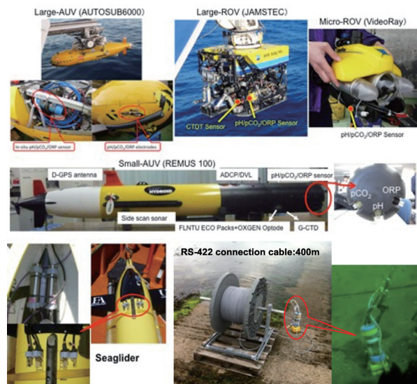
図 12. 現場型 pH/pCO 2 /ORP センサを搭載した種々の海洋観測プラットフォーム
