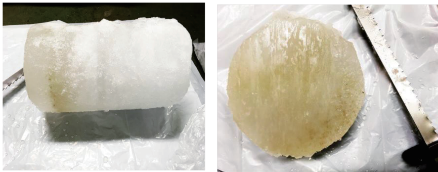
図5. (左) アイスコアラーで採取したオホーツク海の海水 (長さ約40 cm). (右) 海水微細藻類 (アイスアルジー) が濃縮していた海水下層の断面.
